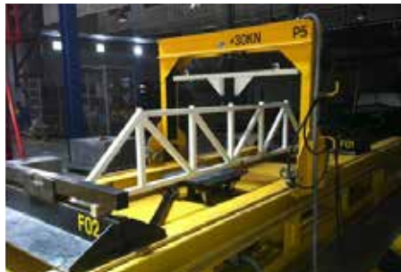
Figure 25- Essais de flexion sur structures à l'échelle 1 (Essais sur treillis)
