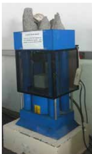
Figure 28- Presse à béton : éprouvettes cylindriques et cubiques
